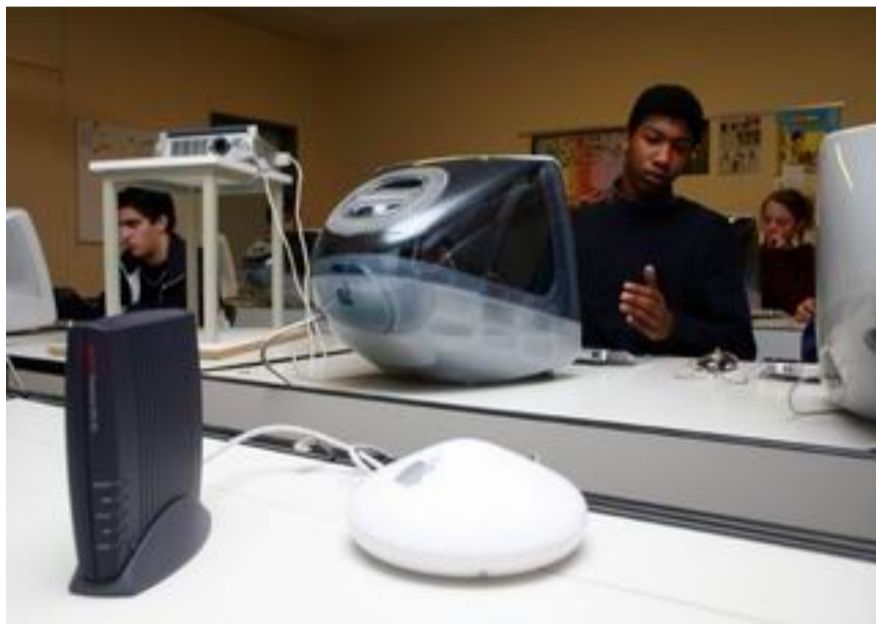
Accès au réseau par la prise électrique (boîtier de gauche) et par un système sans-fil (borne de droite) sont complémentaires, selon le responsable informatique du collège de Saint-Maurice.
